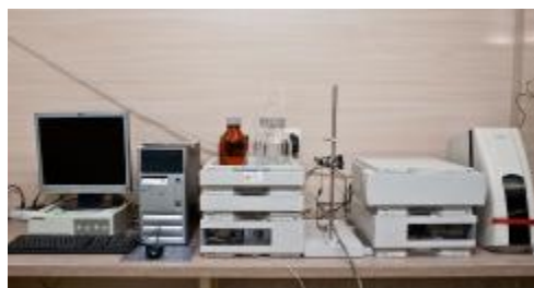
Високоэффективен течен хроматограф Agilent 1100 series, снабден с UV-Vis (DAD) детектор и ELSD (светлинно-разсейващ детектор)
